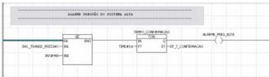
Figura 4.16 - Alarme implementado com apenas 1 linha, a partir da programação baseada na norma IEC61131-3.
